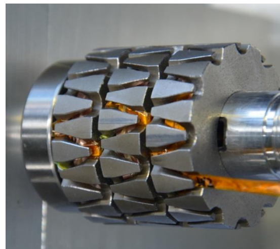
Abb. 1: Dreiphasiger Stator einer Klauenpol-Transversalflussmaschine mit magnetischer Isolation (Luftspalt) zwischen den Strängen.
